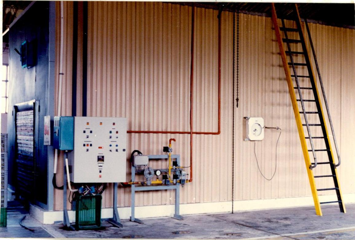
Figura 2. Secador de aire caliente de bandejas (Vista Lateral).
