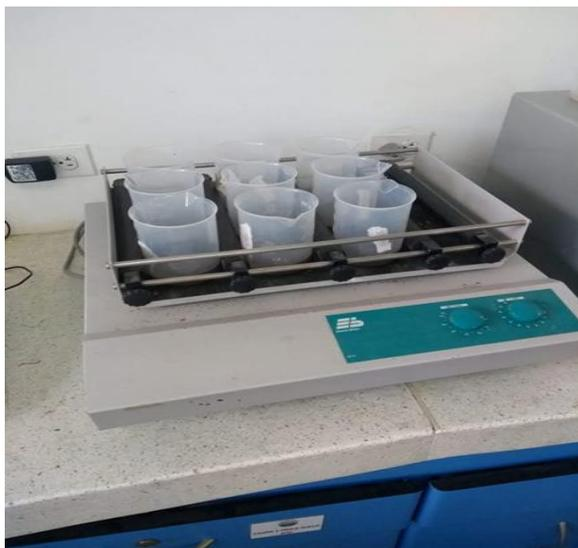
Ilustración 29 foto tomada por Carlos Bellozo, agitadora digital de las muestras de suelo
