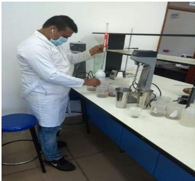
Ilustración 32 tomada por Brayan Fuenmayor, adición de 25 ml de peróxido a los 40 gramos de suelo
