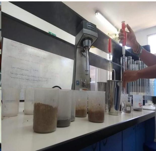
Ilustración 35 tomada por Carlos Bellozo, adición de agua destilada a los 40 gramos de suelo con 25 mil de peróxido
