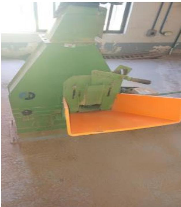
Ilustración 21 tomada por Brayan Fuenmayor, molino utilizado en la molienda de muestras
