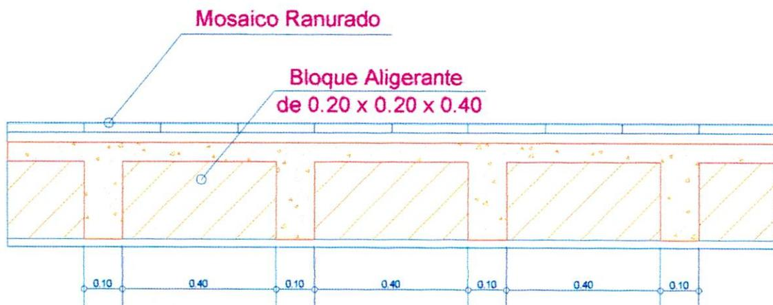
SECCIÓN TÍPICA DE LA LOSA
