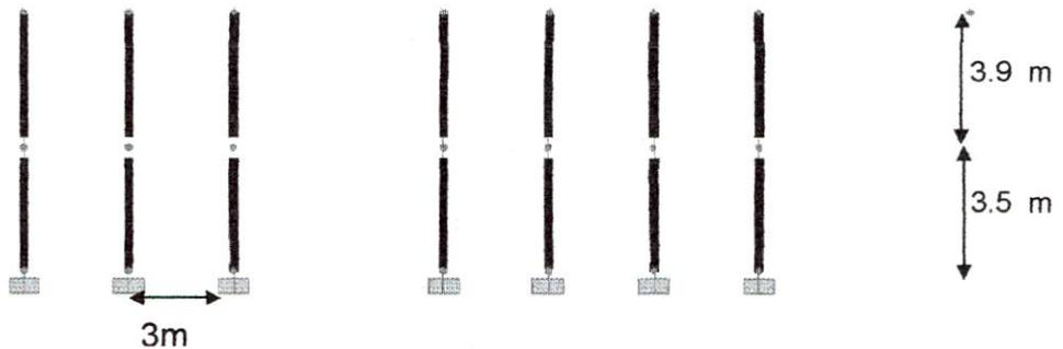
**Figura 14. Pórtico eje H**
