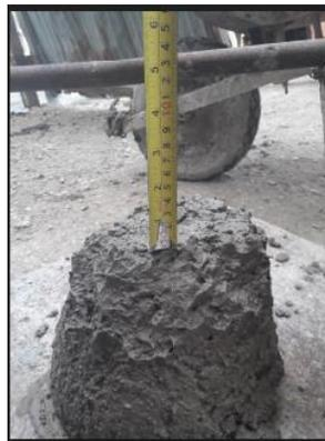
*Anexo A: 9 Ensayos de Calidad y aceptación del concreto. Ensayo de asentamiento y elaboración de probetas para la resistencia a compresión.*
