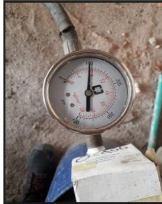
Anexo A: 1 Pruebas de presión en tuberías hidráulicas con Bomba manual hidrostática
