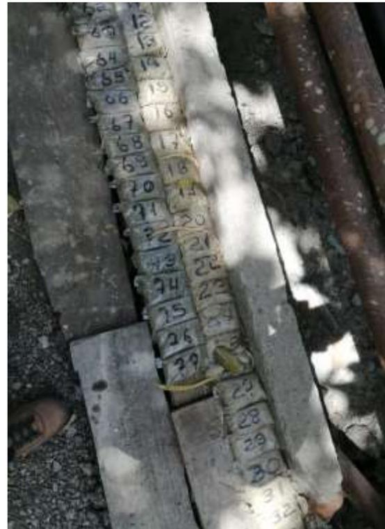
*Ilustración 7. Muestra de suelos por metro de perforación.*
