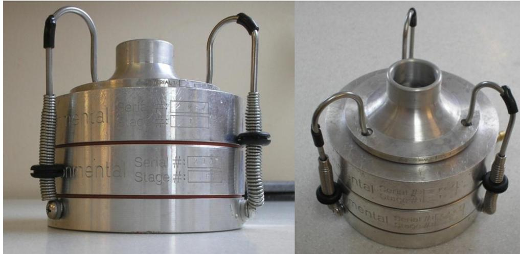
**Figura 7 Impactador de Cascada Marca Tisch Environmental de 2 etapas.**
