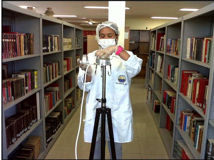
**Figura 3 Colocación de cajas petri en el Impactador de Cascada.**
