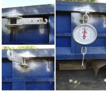
Imagen 10. Mecanismo para el pesaje de los residuos
