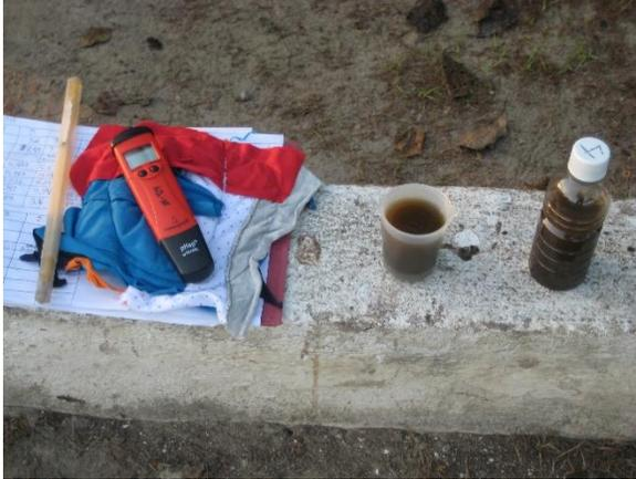
Imagen No. 1: Equipo para toma de muestras a las lagunas de oxidación.
