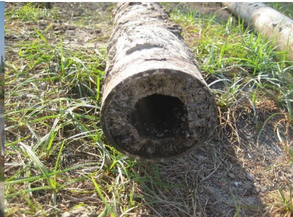
Imagen No. 4: Tubería con diámetro reducido por incrustación de sales.
