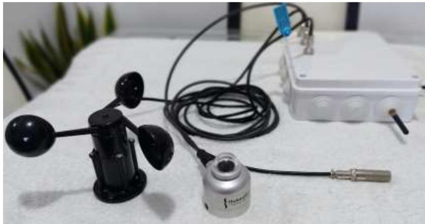
Figura 31. Montaje del prototipo de monitoreo remoto de variables climáticas (exterior).
