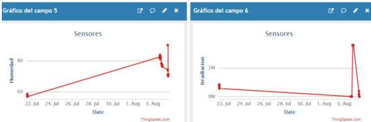
Figura 35. Graficas del comportamiento de la humedad e intensidad de radiación solar.
