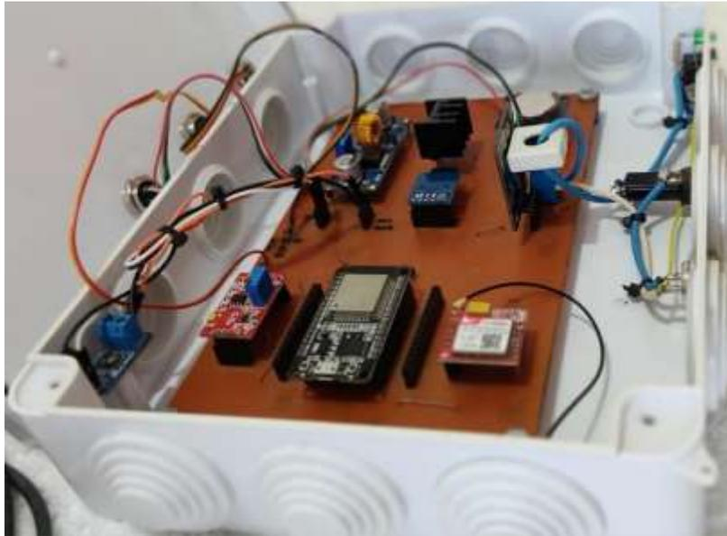
Figura 32. Montaje del prototipo de monitoreo remoto de variables climáticas (interior).
