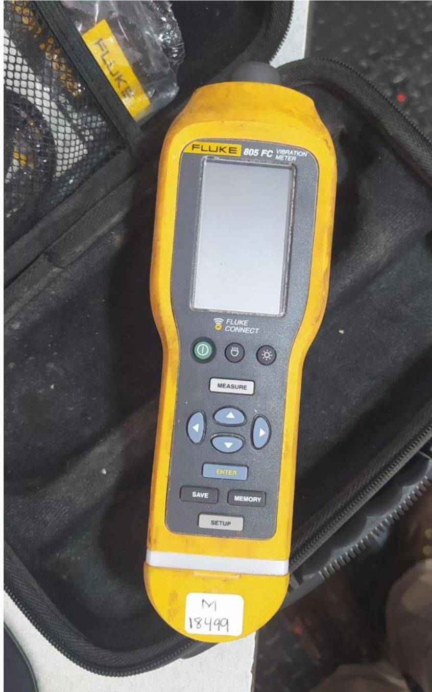
Anexo No. 13: Medidor de vibraciones, equipo de medición de la empresa SPSM.
