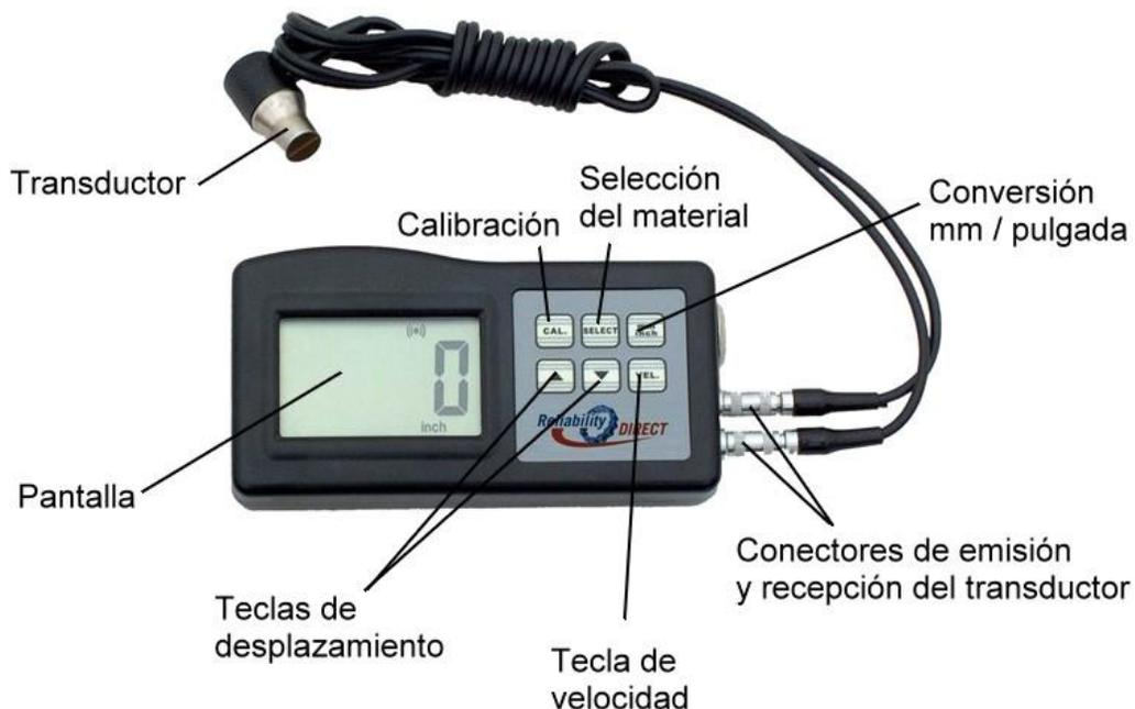
Anexo No. 15: Partes de un Medidor de Espesor por Ultrasonido.
