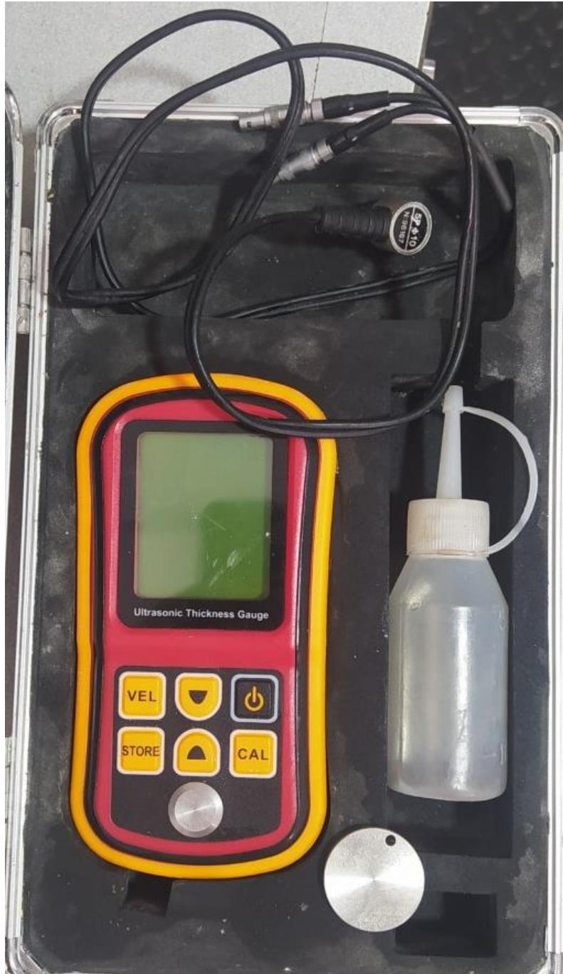
Anexo No. 12: Medidor de espesores ultrasónico, equipo de medición de la empresa SPSM.
