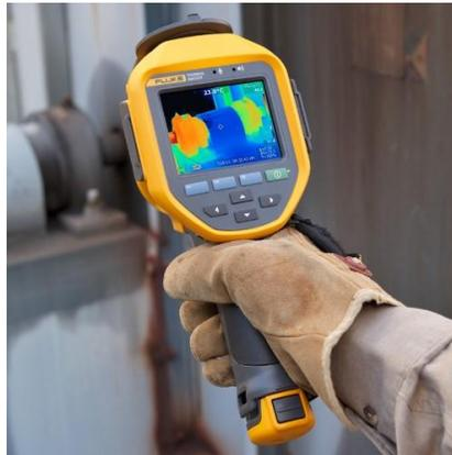
Anexo No. 12: Instrumento utilizado para generar una imagen de radiación infrarroja a partir de la temperatura superficial de las máquinas, “Cámara Termográfica”.
