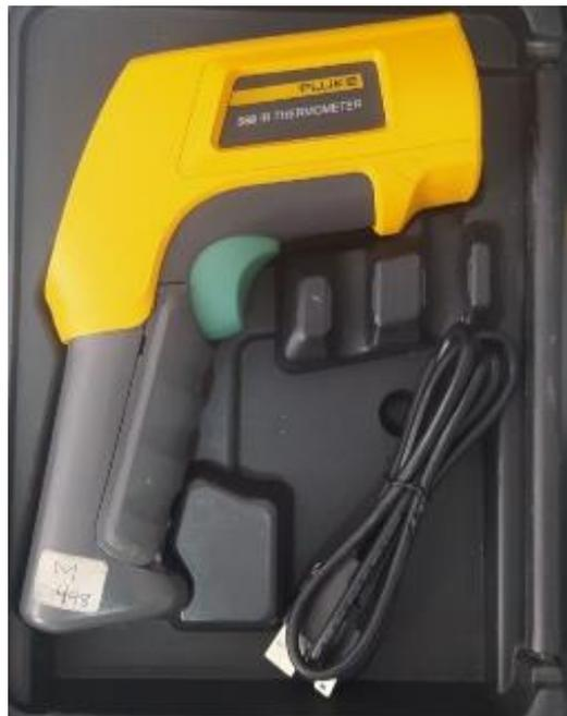
**Anexo No. 15: Termómetro infrarrojo, equipo de medición de la empresa SPSM.**
