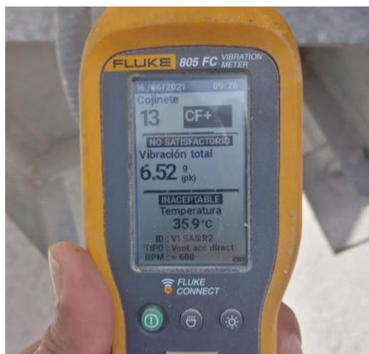
Anexo No. 11: Medidor de vibraciones, mantenimiento preventivo ejecutado en la empresa SPSM.
