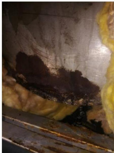
*Ilustración 7: Fuga de agua y corrosión en la parte trasera del autoclave*
