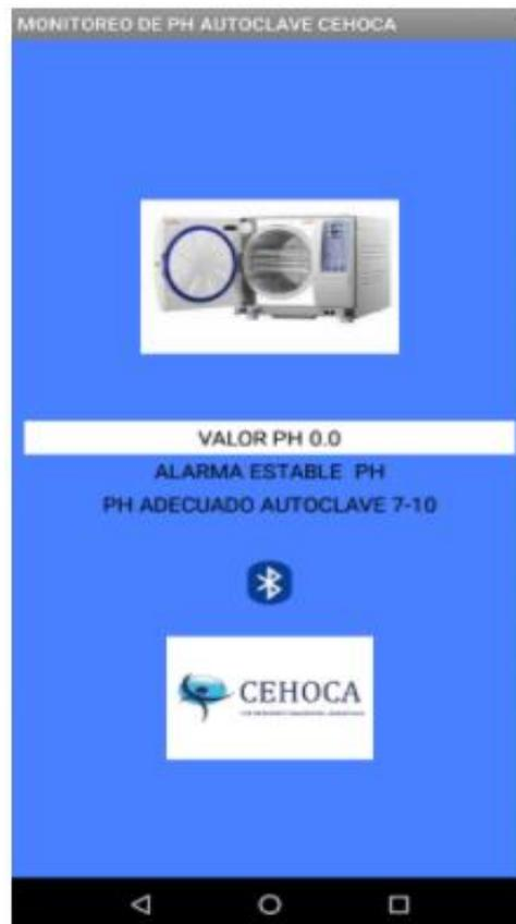
Prueba de funcionamiento del módulo de monitoreo de pH
