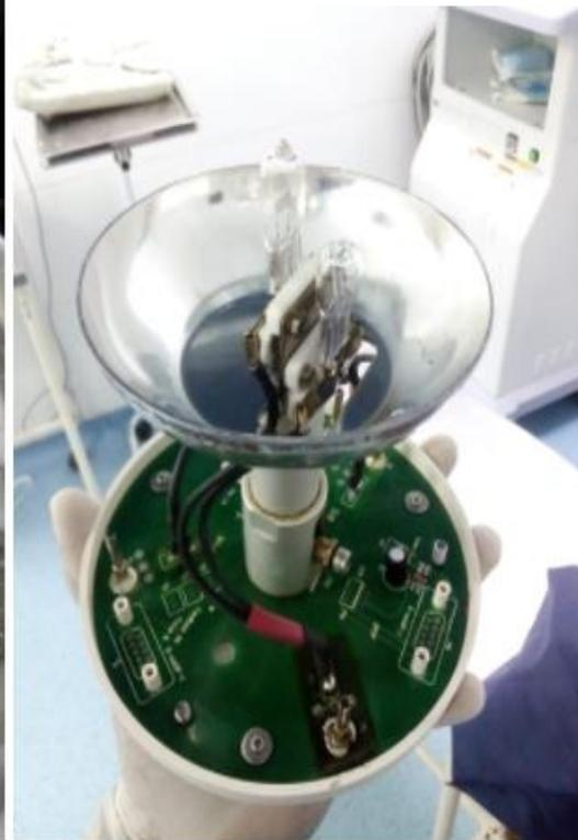
Mantenimiento correctivo, cambio de tarjeta y bombillo para una lámpara cielítica Domelux en el área de cirugía.
