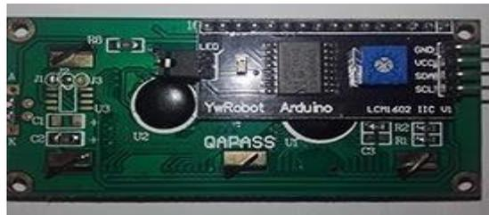
*Ilustración 21: Conexión de la pantalla LCD 16\*2 con el Módulo I2C*
