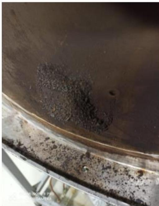
*Ilustración 3: Corrosión en el interior de la autoclave.*
