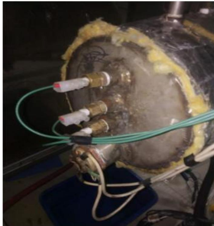
Mantenimiento Preventivo de la autoclave, cambio de sensores de nivel.
