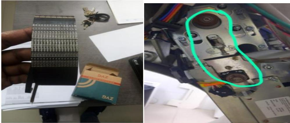
Cambio de correa para el módulo optocoplador del tomógrafo Brivo CT325.
