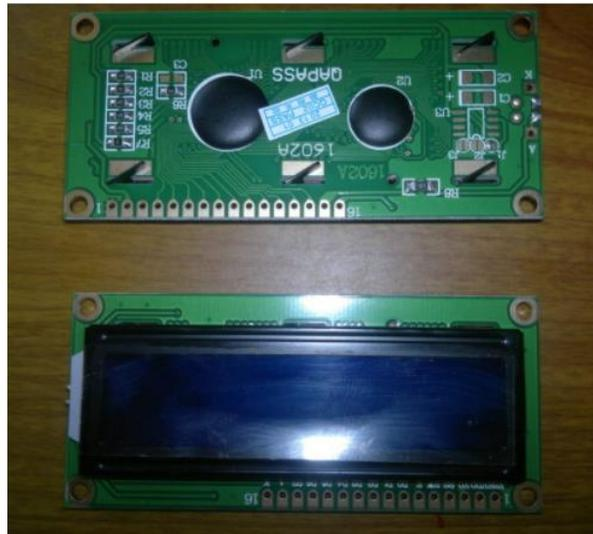
Ilustración 13: LCD 16 \* 2 Fuente: (<http://panamahitek.com/uso-de-pantalla-lcd-con-arduino/>)
