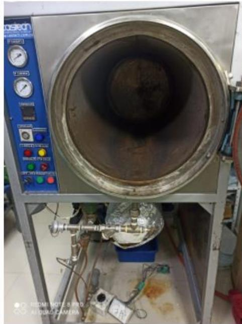
*Ilustración 6: Cara frontal del autoclave*
