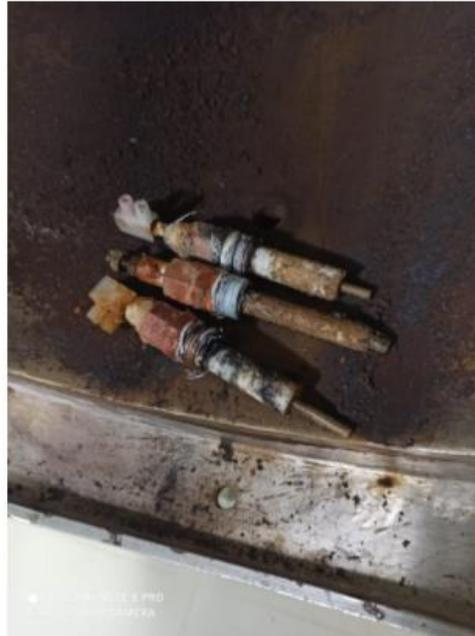
*Ilustración 4: Sensores de nivel en mal estado.*
