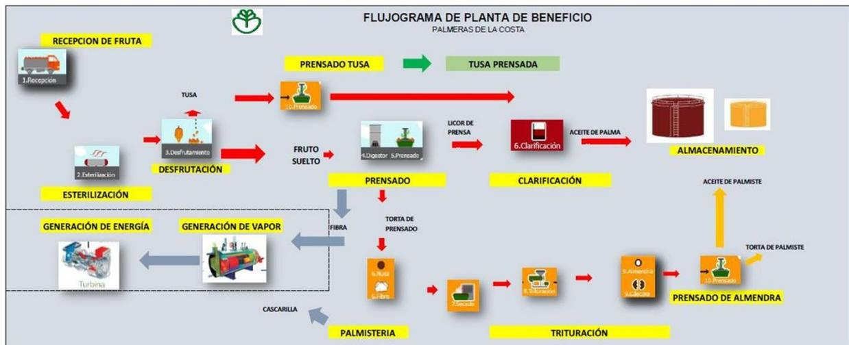
Ilustración 3 – Diagrama de flujo de operaciones planta extractora Palmeras de la Costa s.a.
