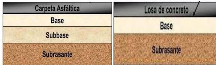
Figura 6. Estructura Pav. flexible
