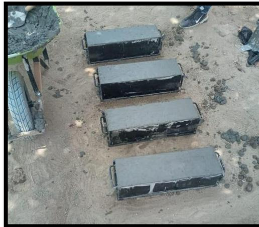
*Figura 41. Cuatro especímenes para luego realizar pruebas de compresión y flexión*
