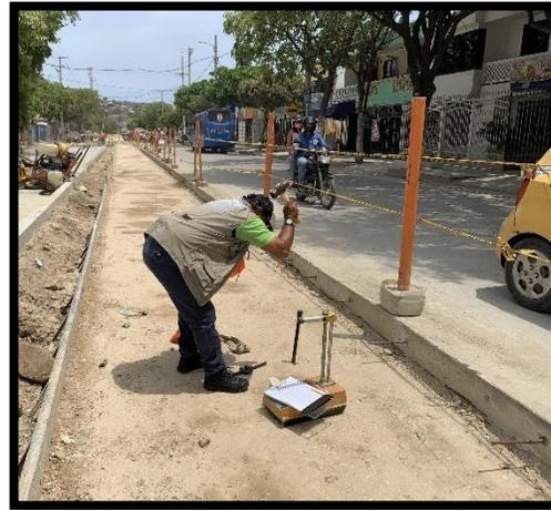
*Figura 21. Toma de densidad de subbase con densímetro nuclear*
