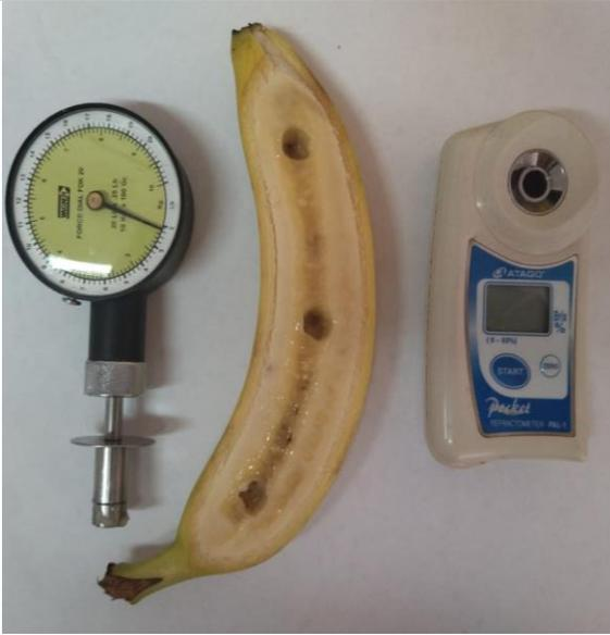
9. Penetrómetro y Refractómetros ( $^{\circ}$ Brix)
