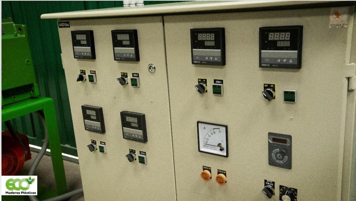
El tablero tiene varias zonas, en dónde se encuentran los contactores, variador de potencia para cambiar la velocidad de la máquina, zonas de calentamiento, voltaje 220, 440, unos reductores con una relación 30/1 muy buenos, con un sistema de poleas y un motor de 30 caballos.
