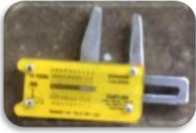
**Calibrador de reloj:** Se utiliza para medir el grado de la fruta identificando aquella que se encuentre dentro del grado adecuado para las especificaciones del cliente.
