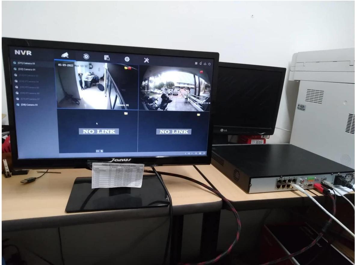
Imagen 31. Verificación de visualización de cámaras instaladas en empresa Interglobal.
