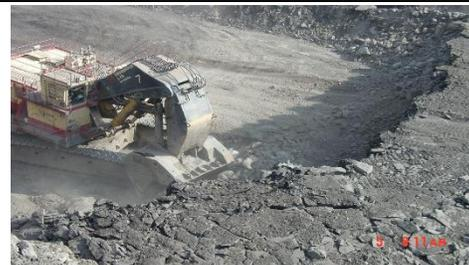
Cuando la pala avanza hasta la cara del corte, el radio de giro aumenta, ocasionando tiempos de cargue más largos. Este tipo de cara o corte también genera una ubicación pobre del camión y más daño de las llantas.
