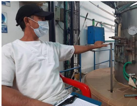
Imagen 9. Operario realizando el control del tiempo, la presión y la temperatura de cocción en la autoclave.
