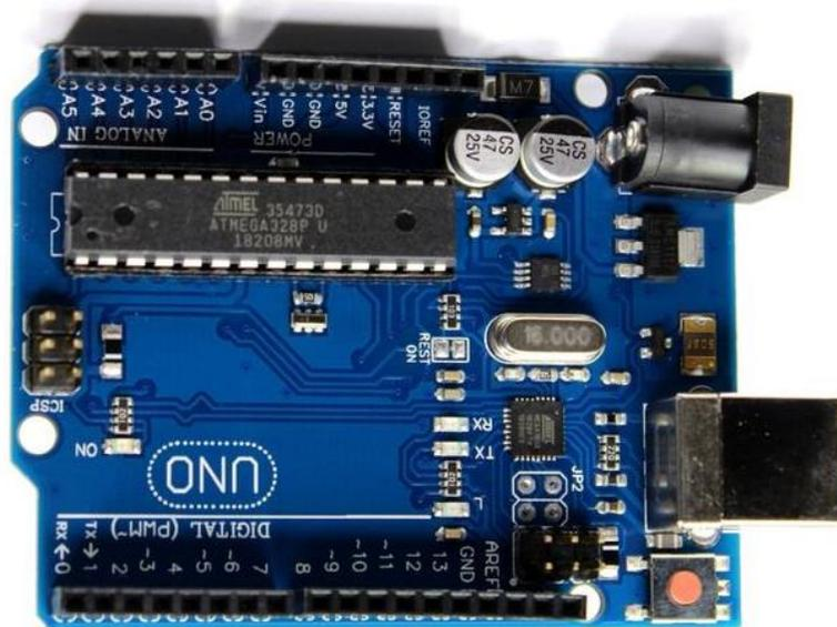
**Arduino (nano, uno, mega):** Arduino es una plataforma de creación de electrónica de código abierto, la cual está basada en hardware y software libre, flexible y fácil de utilizar para los creadores y desarrolladores. Esta plataforma permite crear diferentes tipos de
