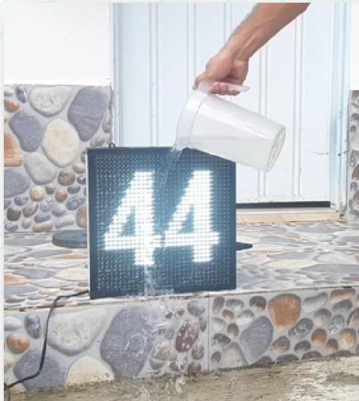
**Nota.** Link para ver el video de la prueba de resistencia al agua
