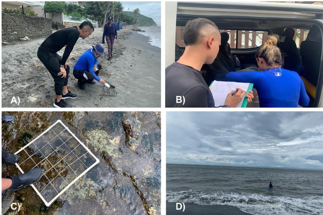
**Figura 11.** A) Toma de muestras de arena para calidad del suelo. B) Toma de datos pruebas In-situ. C) Cuadrilla para evaluación de la Calidad Ambiental por macroalgas. D) Toma de muestras de agua para la Calidad del Agua.
