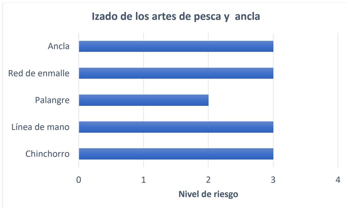
Figura 75. Niveles de riesgos identificados para la tarea de izado en los diferentes artes de pesca evaluados y ancla de la embarcación. Donde izar el chinchorro, la línea de mano, la red de enmalle y el ancla conllevan un nivel de riesgo alto, siendo así necesaria la actuación cuanto antes, mientras que el palangre conlleva un nivel de riesgo medio, siendo así necesaria la actuación.
