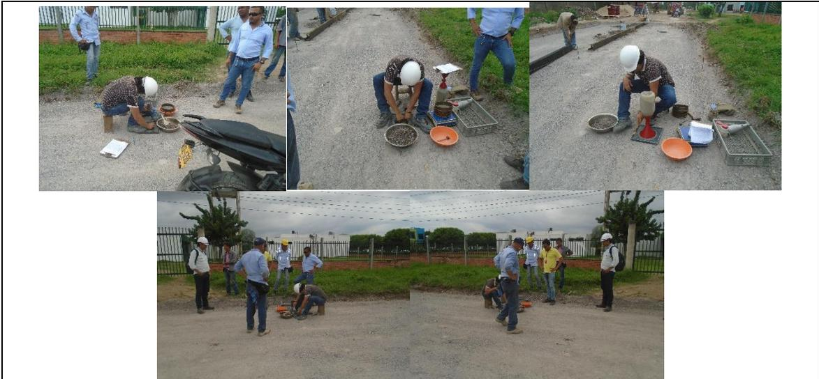
Ensayo de cono y arena para calcular la densidad del suelo
