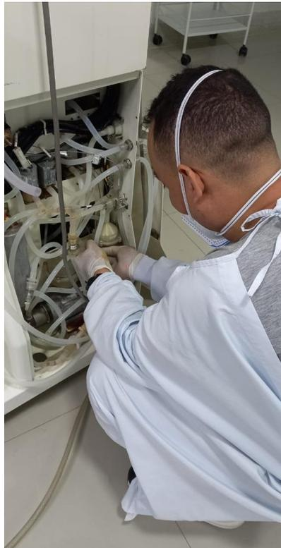
**Imagen 10.** Muchas veces realice mantenimiento correctivos y preventivos de la máquina de diálisis debido a que, esta presentaba errores cuando las tuberías se encontraban sucias, se realizaba limpieza de todos los conductos y los filtros, se programaban lavados en el equipo y se hacía prueba de funcionamiento.
