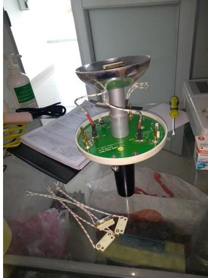
**Imagen 5.** Se hace cambio de socket y conectores de alimentación de módulo de un satélite de lámpara cielítica.
