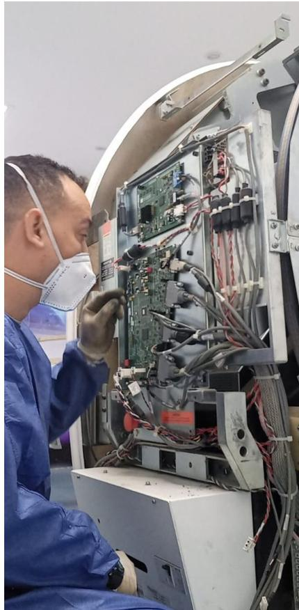
**Imagen 9.** En cada mantenimiento al tomógrafo es fundamental realizar limpieza de las tarjetas electrónicas, verificación de componentes y ajuste de conexiones.
