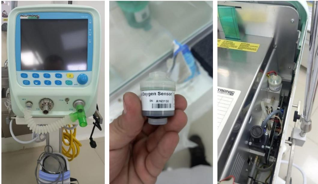
**Imagen 11.** Se realiza mantenimiento correctivo al ventilador de alta frecuencia de UCI neonatal, puesto que tenía el sensor de oxígeno averiado imposibilitando su funcionamiento.
