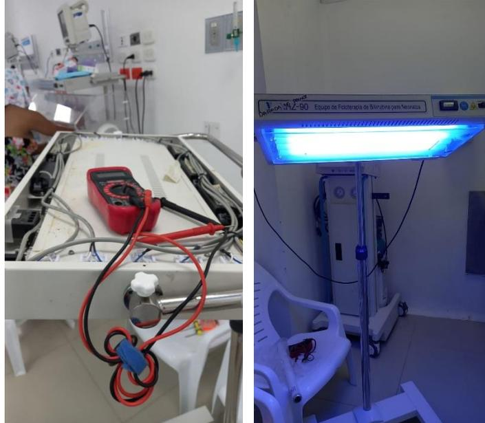
**Imagen 12.** Se realiza cambio de balastro y velas de lámpara de fototerapia en uci neonatal.
