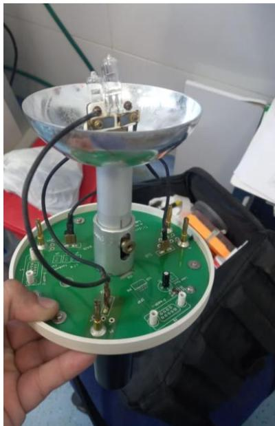
**Imagen 4.** Se realiza cambio de bombillos de alógeno g4 bipin
