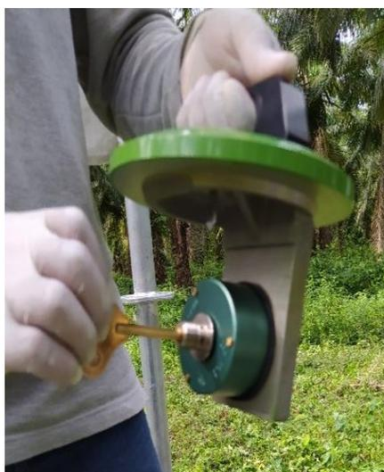
Figura 4: Activación del reloj.
