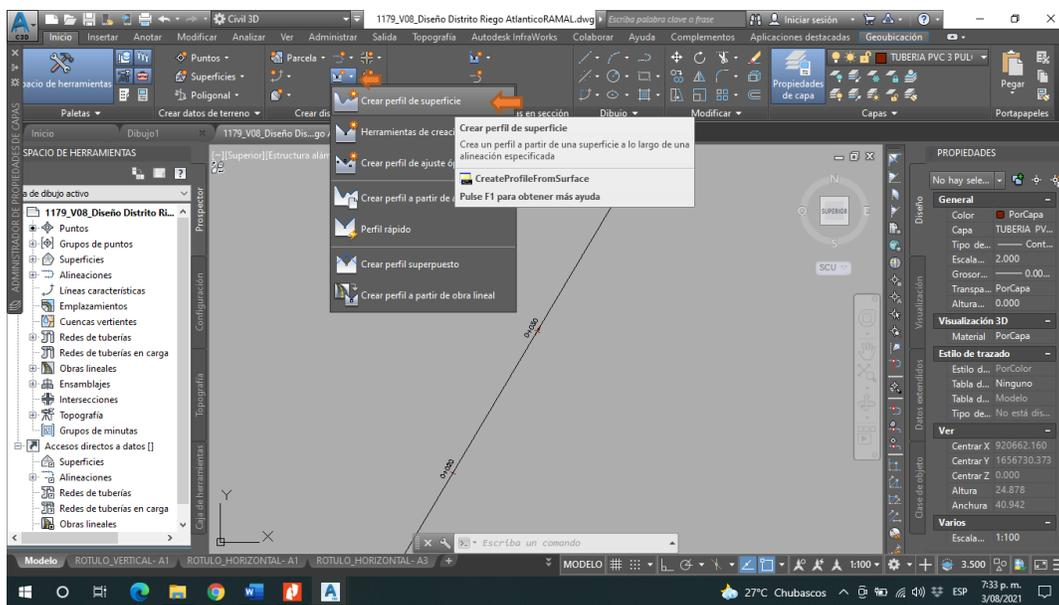
2. Ahora se abre una ventana en la cual en la parte superior izquierda se procede a seleccionar la alineación y en la parte derecha se escoge la superficie (MDT) a partir de las cuales será generado el perfil y se oprime añadir, en el caso de este ejemplo la superficie esta nombrada como MDT. Seguido a esto clic en el botón dibujar visualización de perfil ubicado en la parte inferior central de la ventana.
