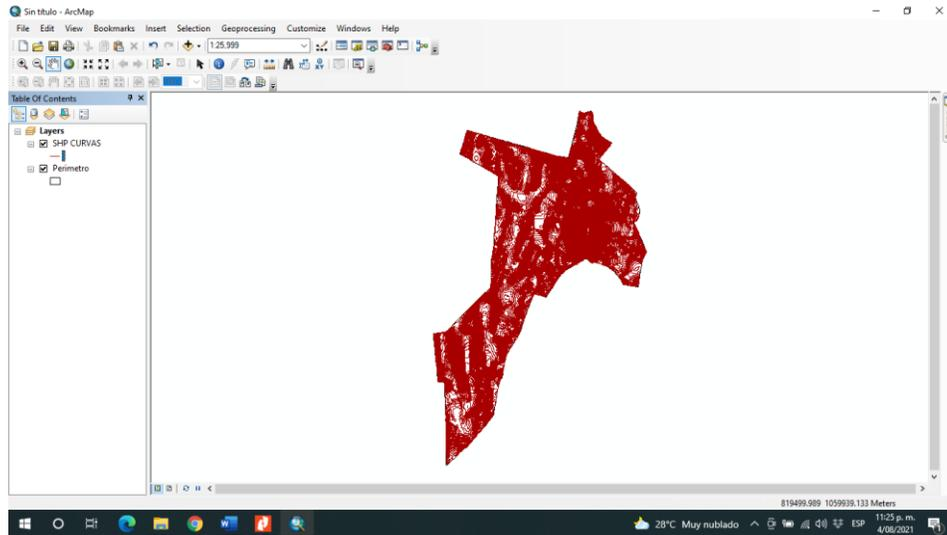
3. Una vez se hayan hecho los pasos anteriores se procede a abrir la pestaña de ArcToolbox, seguidamente se expande la opción de 3D Analyst Tools, luego se expande la opción de Data Management, después se abre la opción TIN y se da doble clic en Create TIN.
