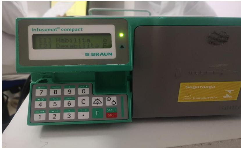
Ilustración 11. Deshabilitación del sensor de goteo.
