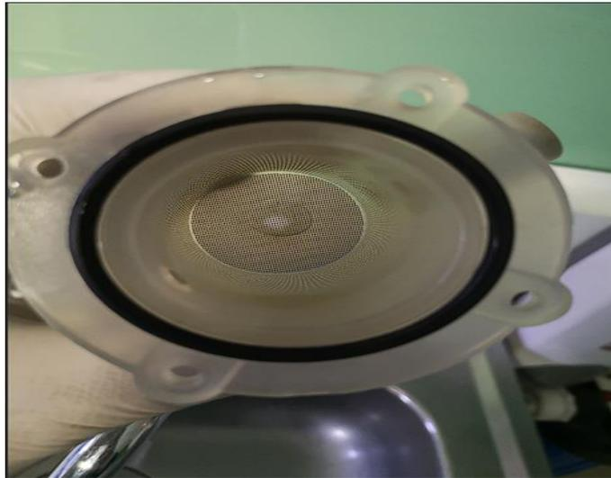
Ilustración 15. Filtro de puerto de lavado después de limpieza.
