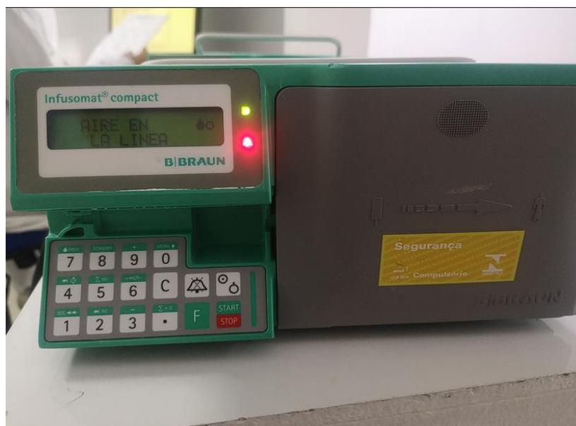
Ilustración 9. Alarma de aire en la línea.
