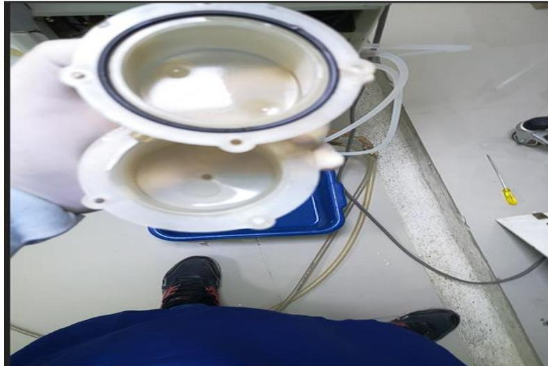
Ilustración 17. Filtro puerto de aire de máquina de hemodiálisis.
