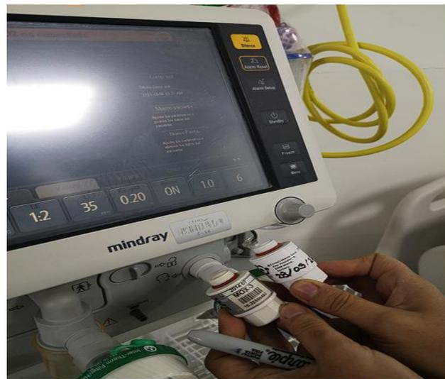
**Ilustración 4. Cambio sensor de oxígeno de ventilador mecánico**
