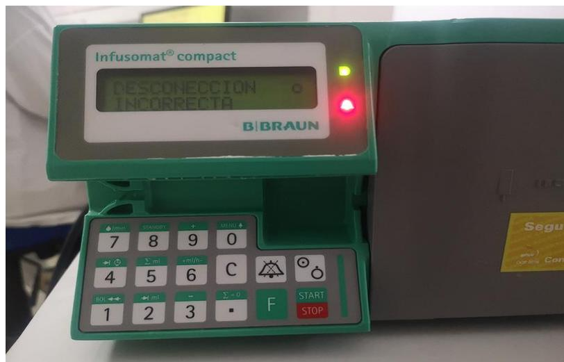
Ilustración 6. Error de desconexión
