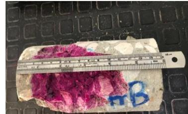
Ilustración 13. Proyección del avance del frente de carbonatación en el tiempo para la Viga 1 entre los ejes A Y B del nivel (N+0.00). con registro fotográfico.
