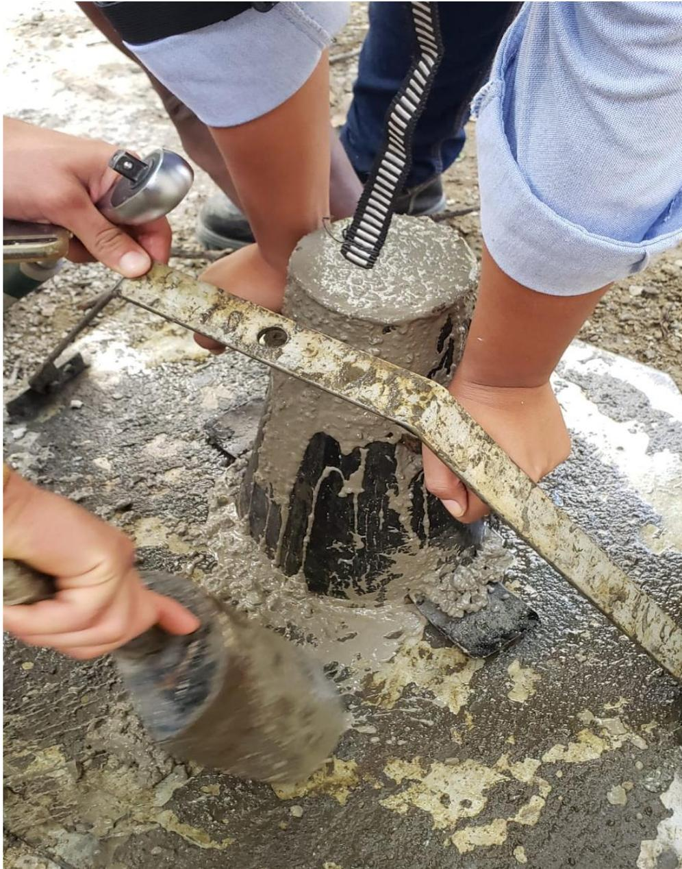
*Ilustración 20. Prueba de Slum*
