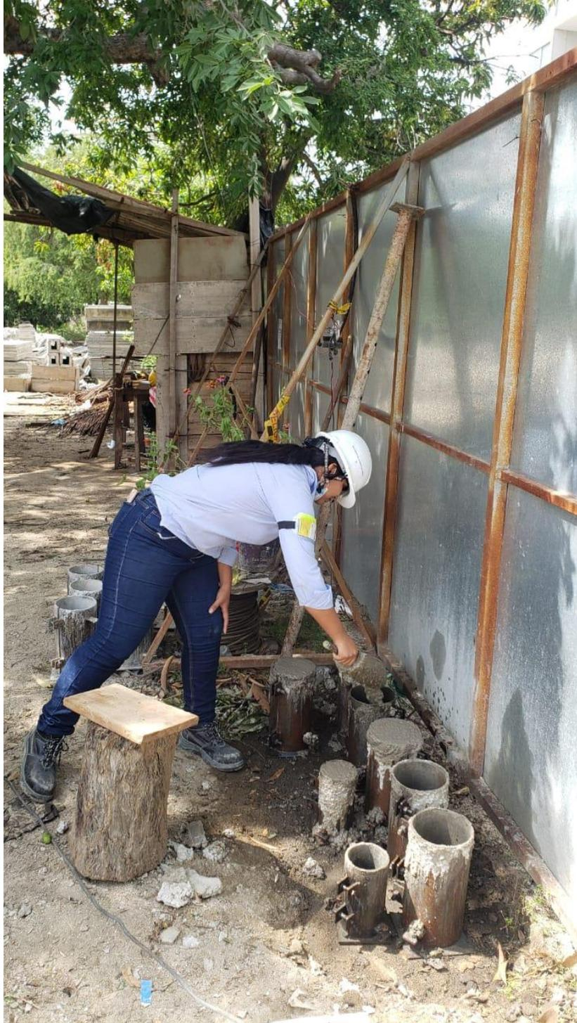
*Ilustración 17. Fabricación de cilindros de concreto*
