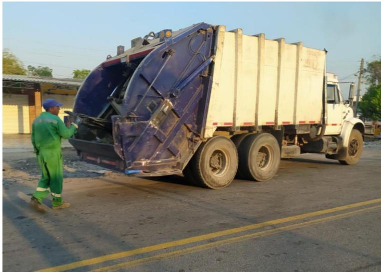
*Figure 33. Vehículo compactador para la recolección de los RS.*
