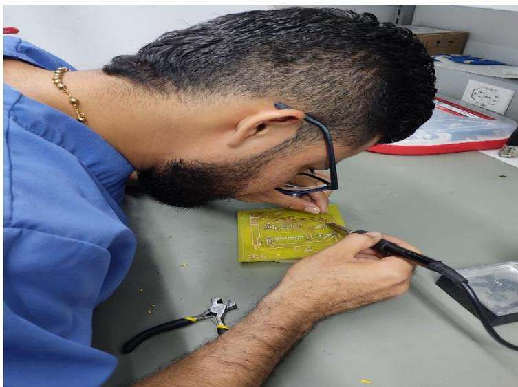
**Ilustración 23 Soldando componentes**
