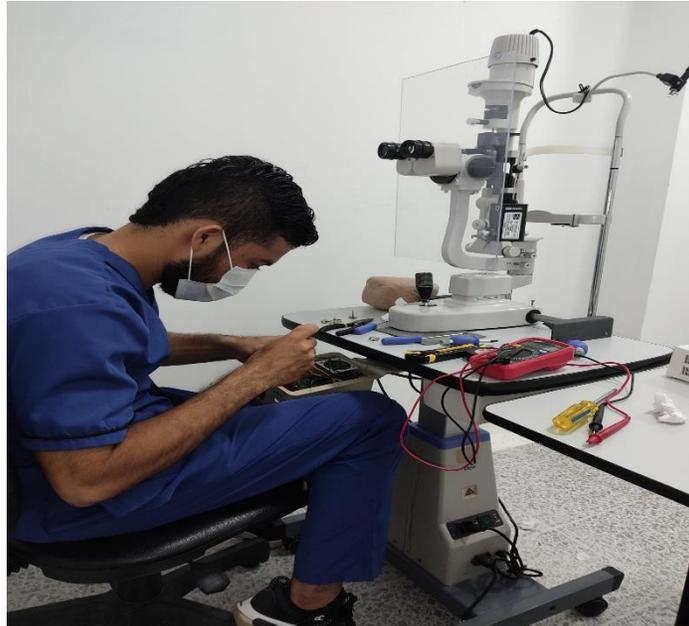
**Ilustración 11 Reparación de lámpara de hendidura**
