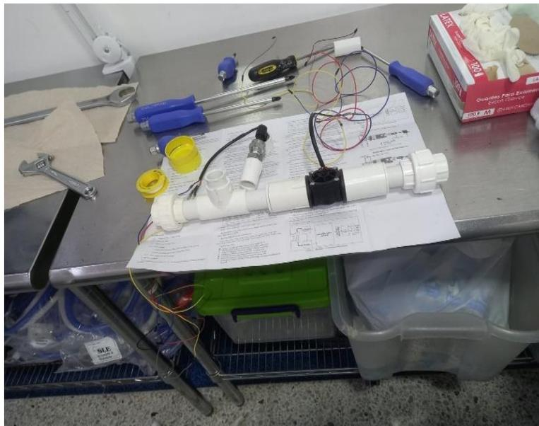
**Ilustración 25 Sensor de presión y flujo**
