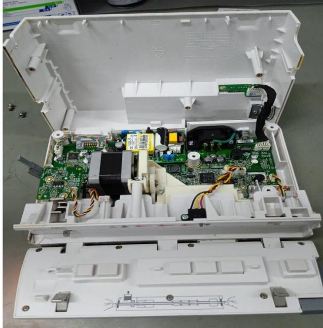
**Ilustración 5 Arreglo de bomba de infusión**
