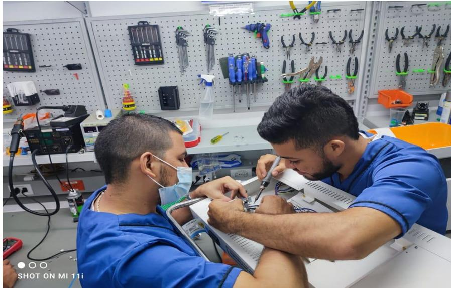
Ilustración 13 Reparación de lampara de fototerapia
