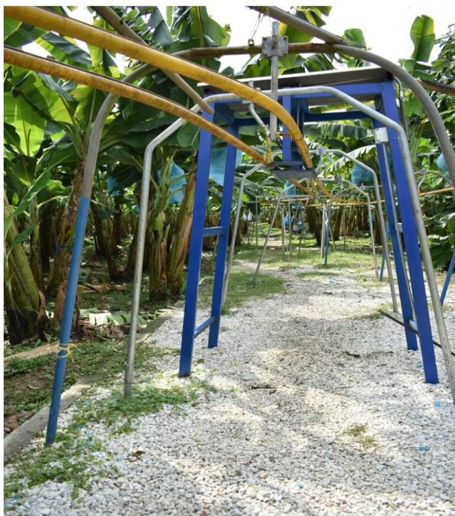
Imagen 14. Estructura con báscula bananera en cable vía.
