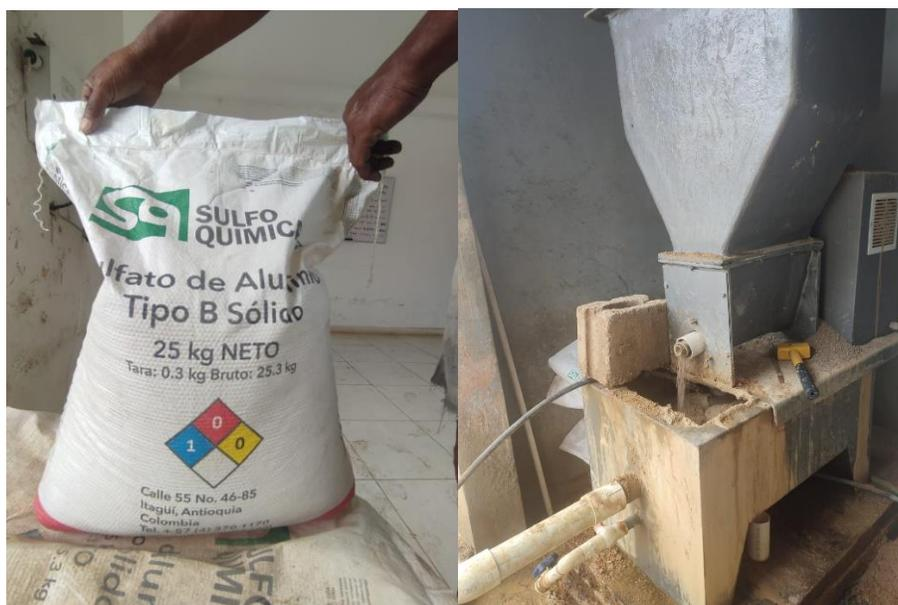
*Imagen N° 11. Dosificador y Sulfato de Aluminio tipo B Fuente: propia*
