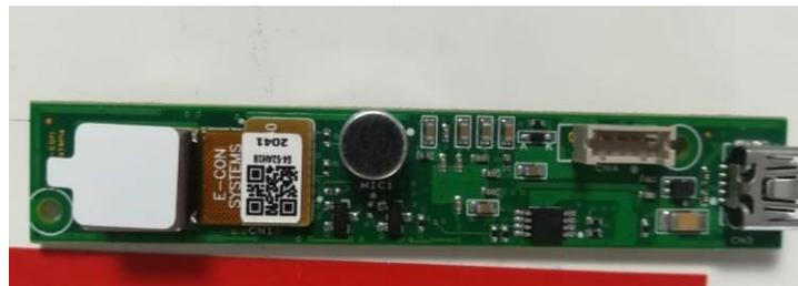
*Figura 5. Módulo de la tarjeta electrónica e-CAM51A\_USB*
